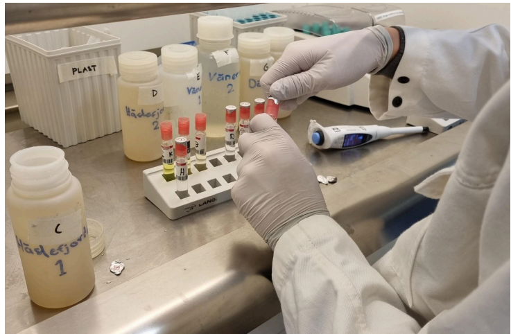
6.7 Förberedelser för kvantifiering av [NH_4-N]
